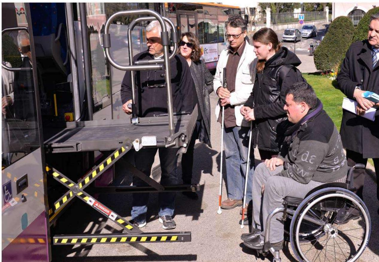
*Plateforme élévatrice équipant un bus de la Ville*
