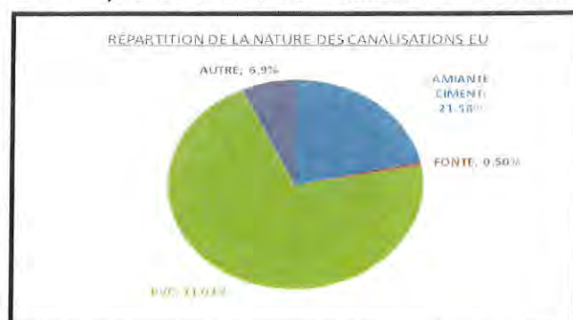
Figure 6 : Répartition de la nature des canalisations d'eaux usées sur la commune de St Jean du Pin
