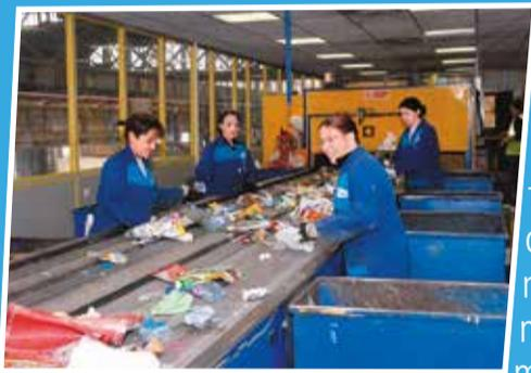
Au centre de tri, les employés complètent le tri préalablement effectué par les habitants : les déchets sont déposés sur un tapis roulant et séparés à la main, par familles de matériaux.
