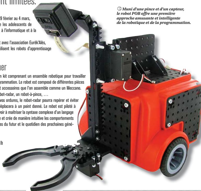
Muni d'une pince et d'un capteur, le robot POB offre une première approche amusante et intelligente de la robotique et de la programmation.
