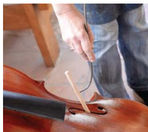
⌚ La pince à âme est un outil très particulier qui permet de positionner "l'âme" sous l'appui droit du chevalet et de régler le son au millimètre près.
